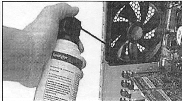
Imagen 4. Limpieza del ventilador
